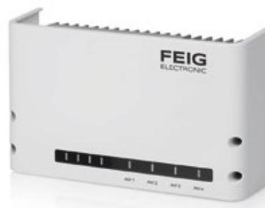
Da Zufahrtskontrollsysteme zu sensiblen Bereichen ein Höchstmaß an Sicherheit aufweisen müssen, verfügt der LRU1002 über ein Secure-Element für die sichere Speicherung von sogenannten Application-Keys, wie sie z. B. von Transpondern mit Ucode-DNA-Chip von NXP verwendet werden. Diese Schlüssel dienen der sicheren Authen-
