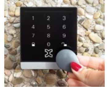
bereich montiert und über PoE mit Spannung versorgt. Die Verwaltung findet zentral durch den integrierten Webserver statt, eine zusätzliche externe Software wird nicht benötigt. Über eine verschlüsselte BUS-Verbindung (bis 1.000 m Länge) kommuniziert das Relais-Modul mit dem IP-Wandleser. Dieser lässt sich einfach in der Schalterdose oder mit Aufputz-Gehäuse (optional) im Bereich der Tür montieren.
